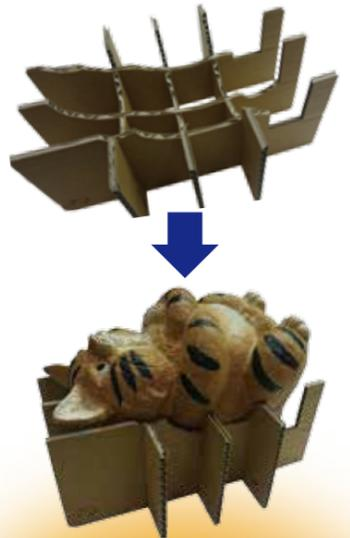
MYPAC BOX-Designを使い2D展開図を作成後、カッティングマシンASXにて猫の置物にフィットした緩衝材を作成。
