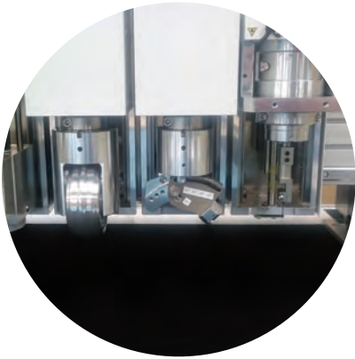
最大4軸まで拡張できるヘッド構成
