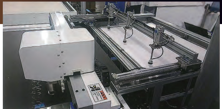
ベルトコンベア搭載の自動給紙、 排紙による無人化カッティングマシンの実現。
