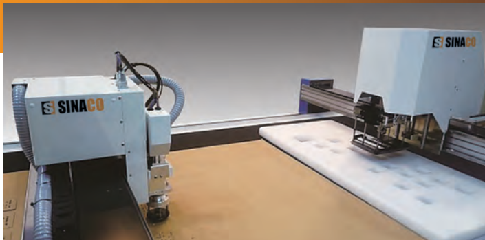
ツーマーム・ツーヘッドオプションを使用して目的の違う加工を実現。
