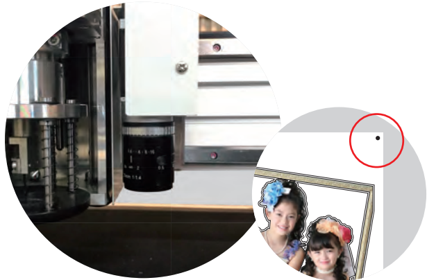
自動垂直平行補正カットを行うトンボ認識機能
